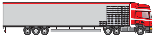
Rücktransport: 64 leere DUROPAC-Systeme auf ca. 3,2 Lademetern
