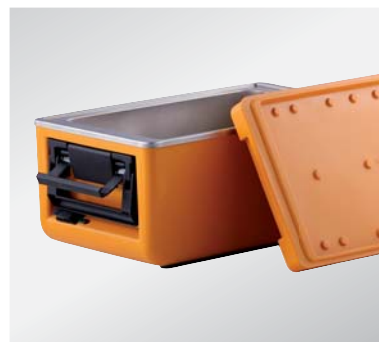
Thermobox, s PUR-vypěněním, nádoba Single-Sheet se zrcadlovým svařením, víko Twin-Sheet
